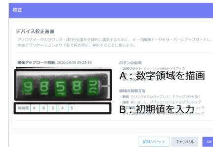
A：校正操作を行い、数字を一桁ずつ指定してください。操作方法は校正画面に記載されています。
